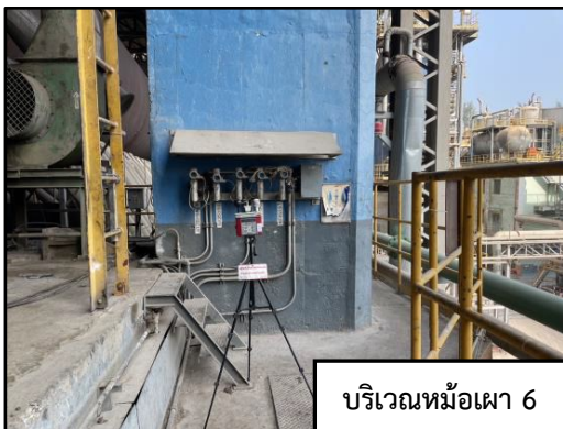
ภาพที่ 3.150 การตรวจวัดความร้อนในสถานที่ทำงานบริเวณหม้อเผา 6 และ บริเวณ Preheater
