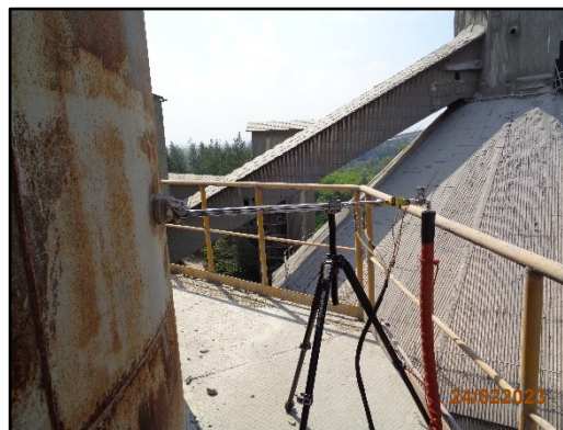
ภาพที่ 3.13 การตรวจวัดคุณภาพอากาศจากปล่องหม้อเย็น 6
