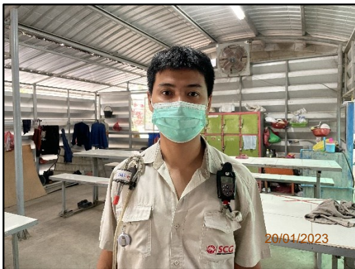
ภาพที่ 3.109 การตรวจวัดฝุ่นที่พนักงานสัมผัส ในสถานที่ทำงานของพนักงาน ประจำหม้ออบซีเมนต์ 7-9
