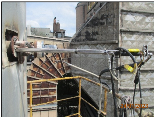
ภาพที่ 3.11 การตรวจวัดคุณภาพอากาศจาก ปล่องหม้อเย็น 4
